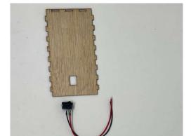
Étape 3 : Installer l'interrupteur Repérer la pièce latérale qui a une ouverture carrée, passer le fil dans l'ouverture et appuyer sur l'interrupteur pour le fixer bien en place
